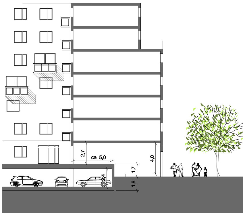
Eingeschoßige Split-Level-Garage, Schnitt 1:200
