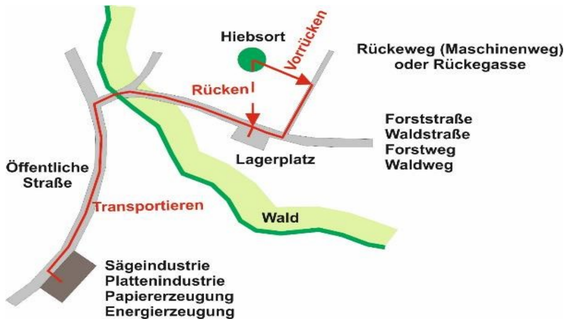
Abbildung 5: Der Vorgang, bei dem Bäume oder Baumteile vom Hiebsort zum Ort der Lagerung an die Forststraße transportiert werden, wird als „Rücken“ bezeichnet, während das Verfrachten des Holzes auf Forst- und öffentlichen Straßen vom Lagerplatz zum Abnehmer als „Transportieren“ bezeichnet wird (Quelle: Stampfer 2020).
