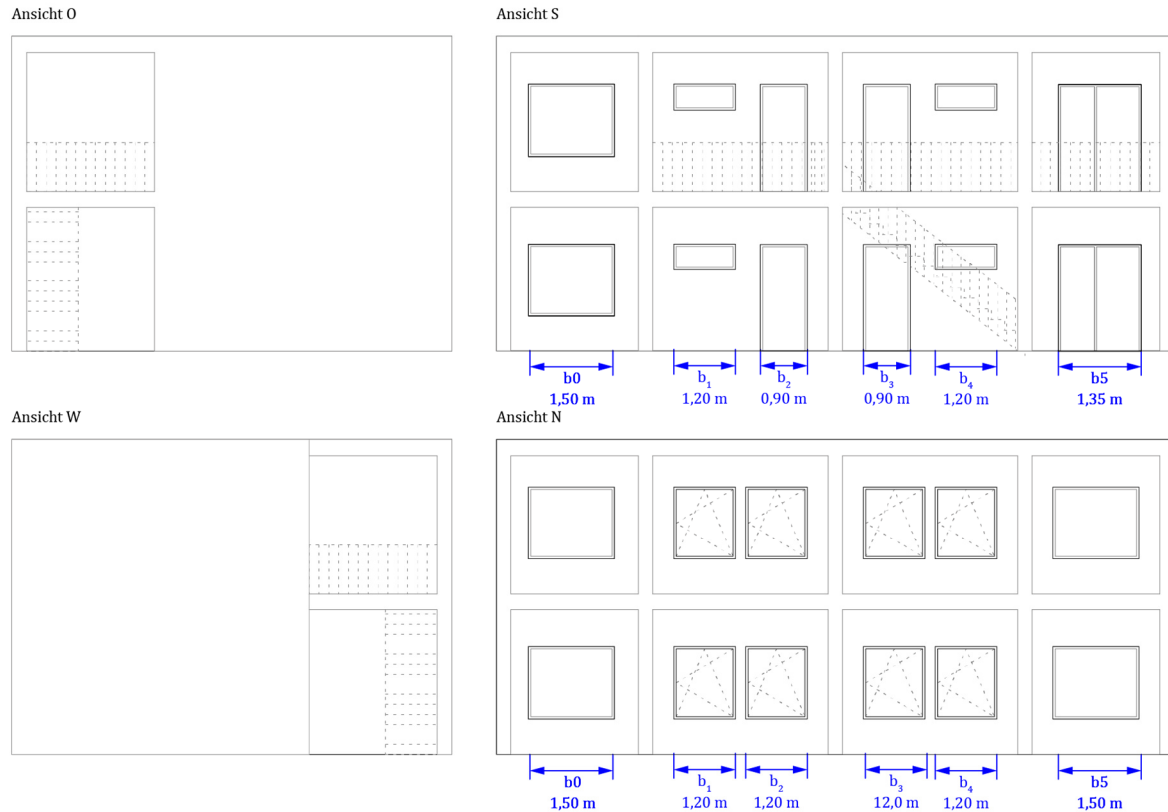
Abbildung 16: Ermittlung aller Öffnungsbreiten an jeder Gebäudefassade
