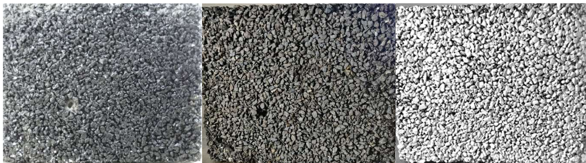
Abbildung 4-6 Dokumentation: PA 8 20/30, nicht sandgestrahlt (links), sandgestrahlt (Mitte) und weiß angestrichen (rechts)
