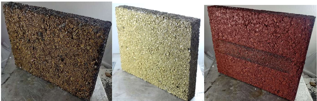
Abbildung 4-8 Dokumentation: AC 11 trans (links), AC 8 gelb (Mitte) und AC 11 rot (rechts) alle nicht sandgestrahlt
