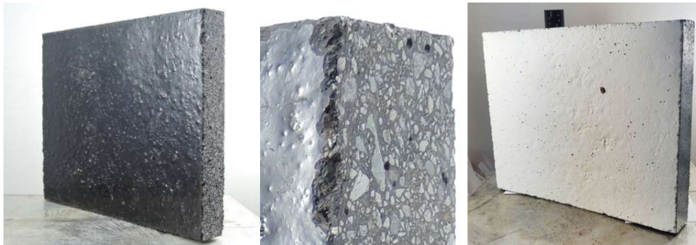
Abbildung 4-2 Dokumentation: MA 8 20/30, nicht sandgestrahlt (links und Mitte) und MA 8 20/30 weiß (rechts)
