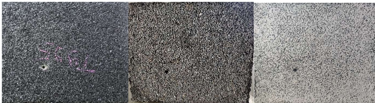
Abbildung 4-4 Dokumentation: PA 4 20/30, nicht sandgestrahlt (links), sandgestrahlt (Mitte) und weiß angestrichen (rechts)
