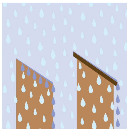
Abb. 30: Holzschäden durch eindringendes Wasser (GREEN4CITIES 2024 & 2022)
