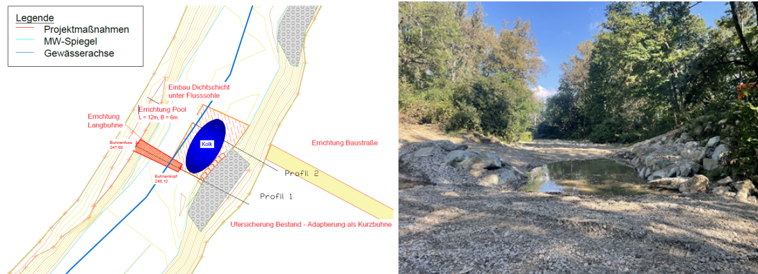
Abbildung 27 Ausführungsprojekt Fischrettungspool Leitha (links), Fischrettungspool Leitha nach Fertigstellung 2025 (rechts)
