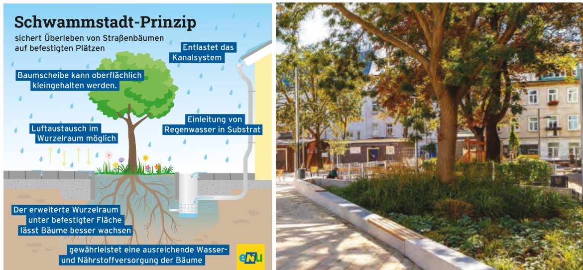
Abbildung 44 Schwammstadtprinzip Stadtbäume © Energie- und Umweltagentur des Landes NÖ (links), Erste Parkanlage mit Schwammstadtprinzip – Wien 18., Parkanlage Johann-Nepomuk-Vogl-Platz (rechts)
