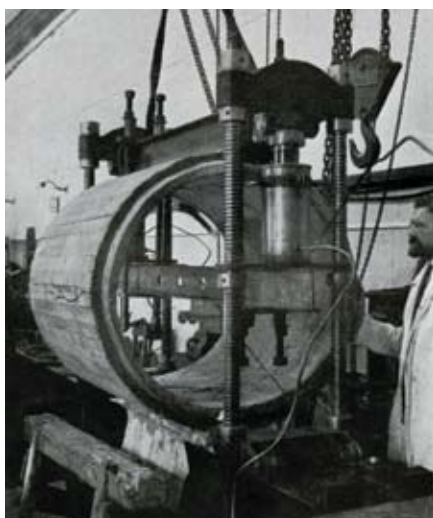
Prüfung eines Betonrohres, um 1900
