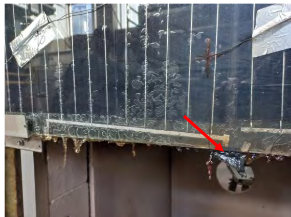
Abbildung 10-4: Austreten von geschmolzener Folie
