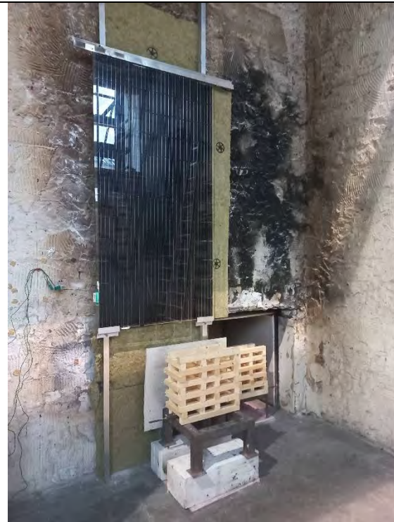
Abbildung 9-12: Prüfanordnung vor dem Brandversuch (die Holzkrippe im Brandraum war nicht Bestandteil des Versuches)
