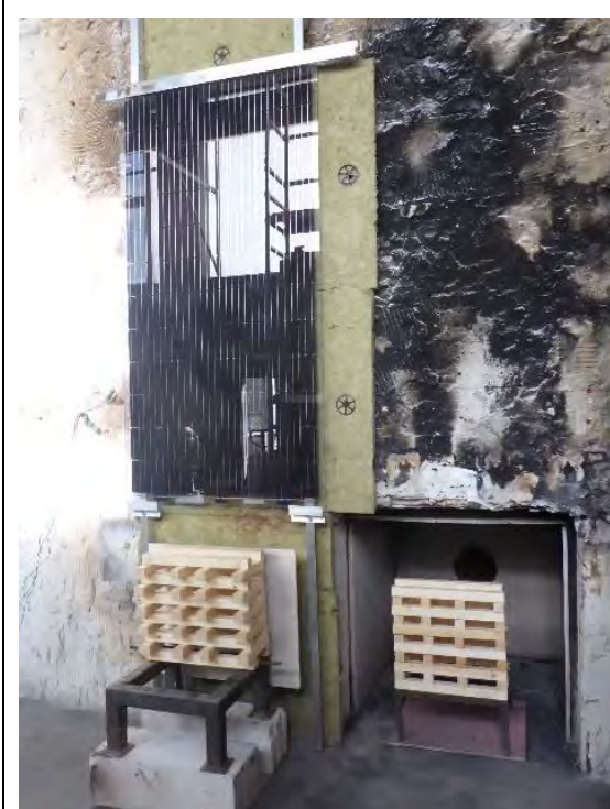
Abbildung 9-18: Prüfanordnung vor dem Brandversuch (Holzkrippe im Brandraum war nicht Bestandteil des Versuches)
