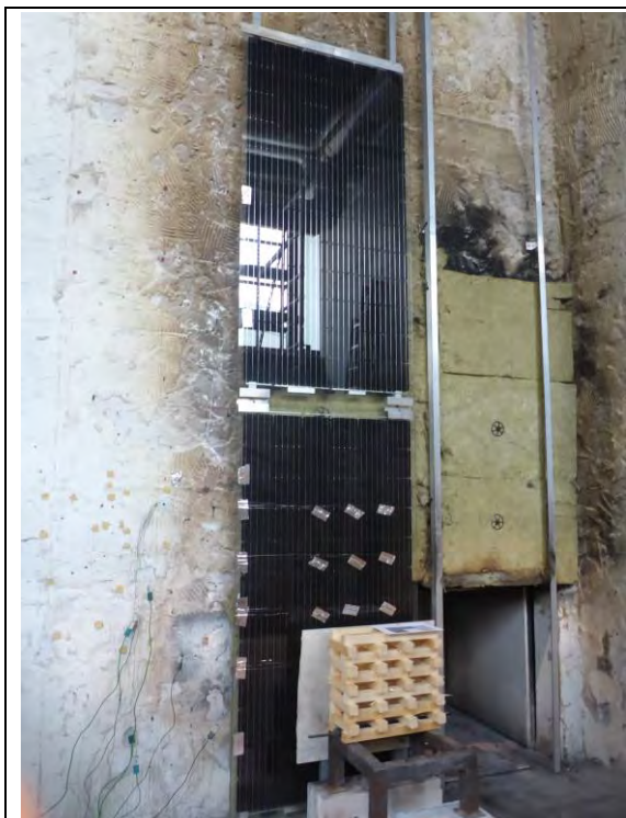
Abbildung 9-29: Prüfanordnung vor dem Brandversuch
