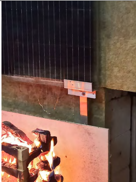
Abbildung 9-13: PV-Module nach dem Brandversuch
