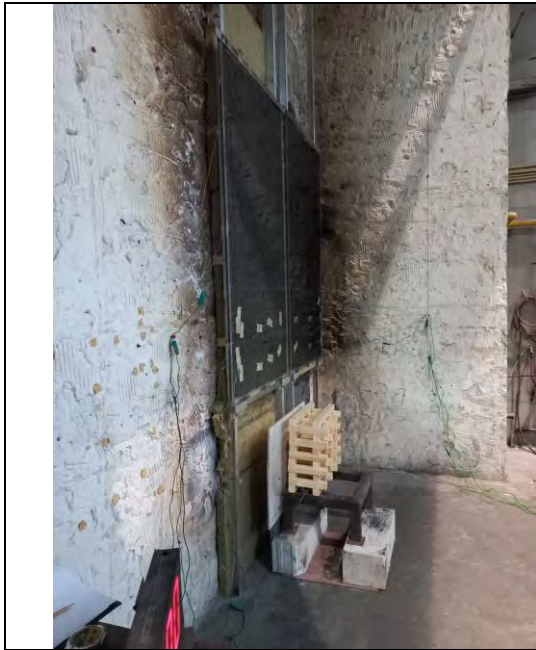
Abbildung 9-22: Prüfanordnung vor dem Brandversuch
