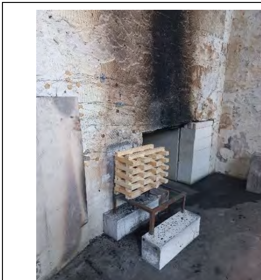
Abbildung 8-14: Aufnahme der Holzkrippenanordnung
