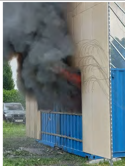
Abbildung 7-6: Versuchsdurchführung (der Flammenaustritt am Fenstersturz ist ersichtlich)
