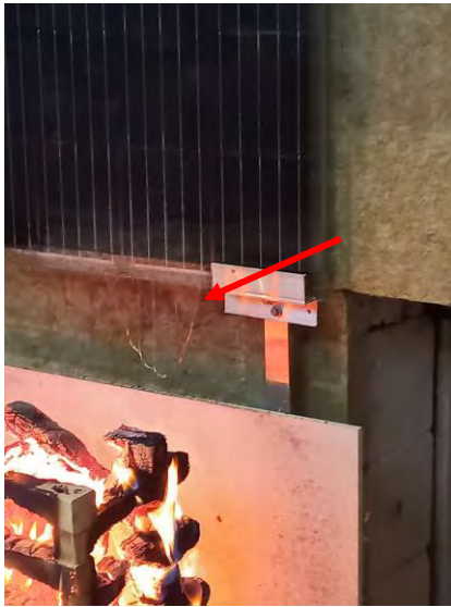
Abbildung 10-1: Austreten von geschmolzener Folie
