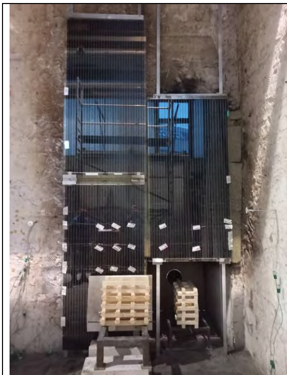
Abbildung 9-36: Prüfanordnung vor dem Brandversuch (Holzkrippe im Brandraum war nicht Teil des Versuches)
