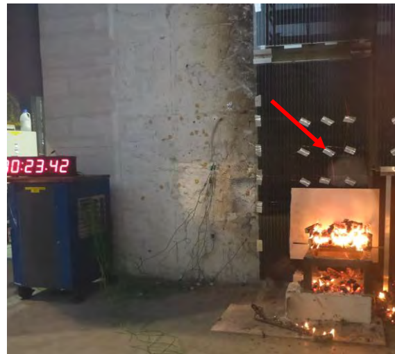
Abbildung 10-2: optische Veränderung am PV-Modul
