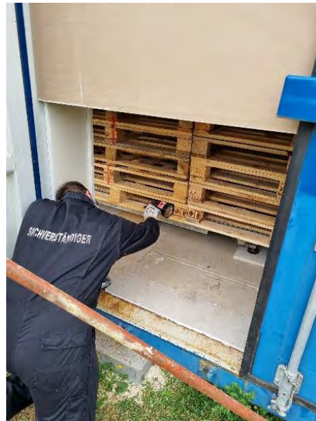
Abbildung 7-8: In Brand setzen des Ethanols in einer Wanne unter dem Palettenstapel
