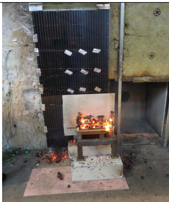
Abbildung 9-32: PV-Module nach dem Brandversuch
