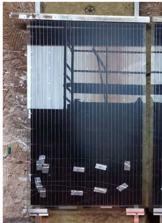
Abbildung 9-19: PV-Module nach dem Brandversuch
