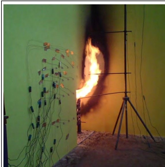
Abbildung 8-7: Flammenaustritt aus dem Brandraum während des Brandversuches
