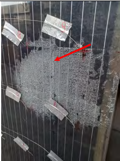
Abbildung 10-3: optische Veränderung am PV-Modul
