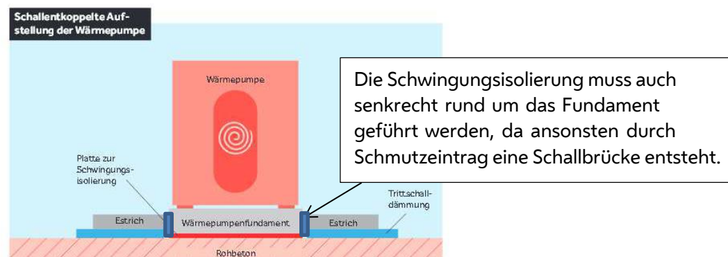
Abb. 26 Körperschall entkoppelte Aufstellung der Wärmepumpe Quelle: AIT 2013
