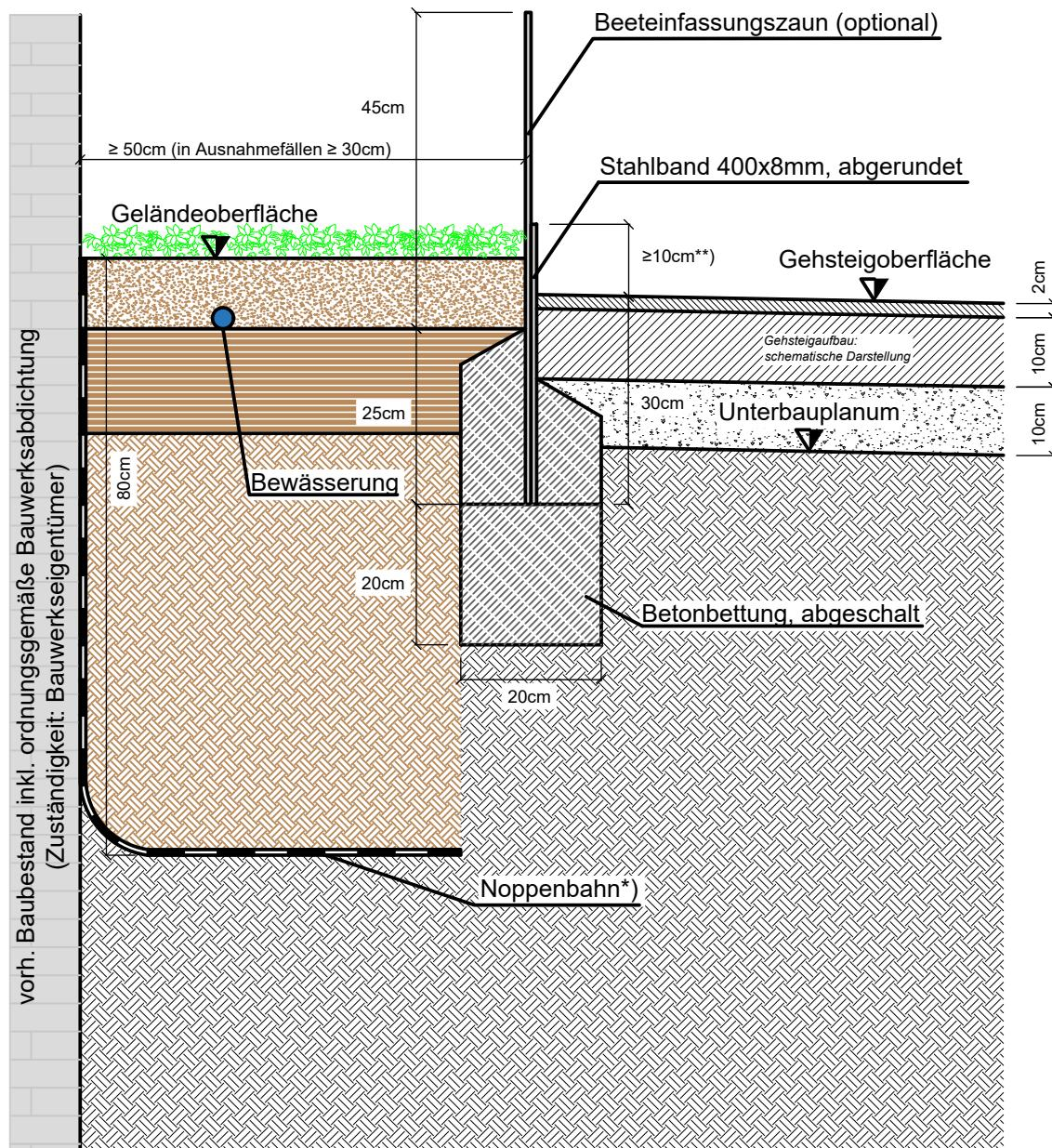
Hinweis: Einfassungen von Fassadenbegrünungen sollen in der Gehlinie einen trapezförmigen Grundriss (längere Seite an der Hausmauer) aufweisen, um eine bessere Erstastbarkeit mit dem Taststock zu gewährleisten. Als Richtwert gilt: die Innenwinkel an der Hausmauer sollen  $\leq 60^\circ$  (besser  $45^\circ$ ) betragen.
