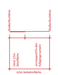
Schnitt für den Trude-Mally-Weg im Abschnitt mit einer Gesamtbreite von 9m
