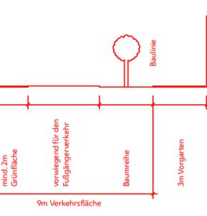
Schnitt für Verkehrsflächen mit einer Gesamtbreite von 10m
