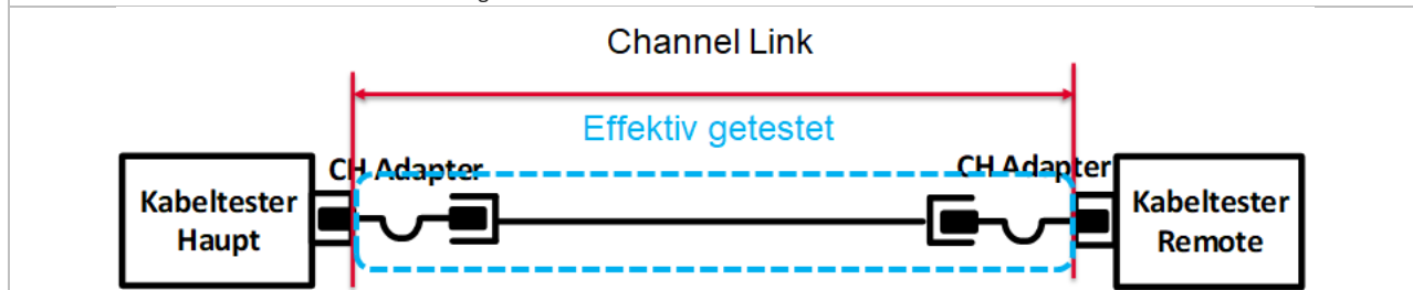
Abbildung 8: Link und Channel Messaufbauten - Channel Link
