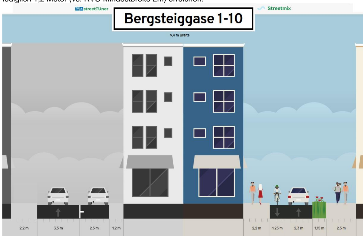
Fig. 2. Links: Der aktuelle, nicht RVS-konforme Straßenquerschnitt. Rechts: Ein möglicher Straßenquerschnitt bei Einhaltung der RVS-Mindestbreiten für Verkehrsanlagen aller Verkehrsteilnehmer_innen.
