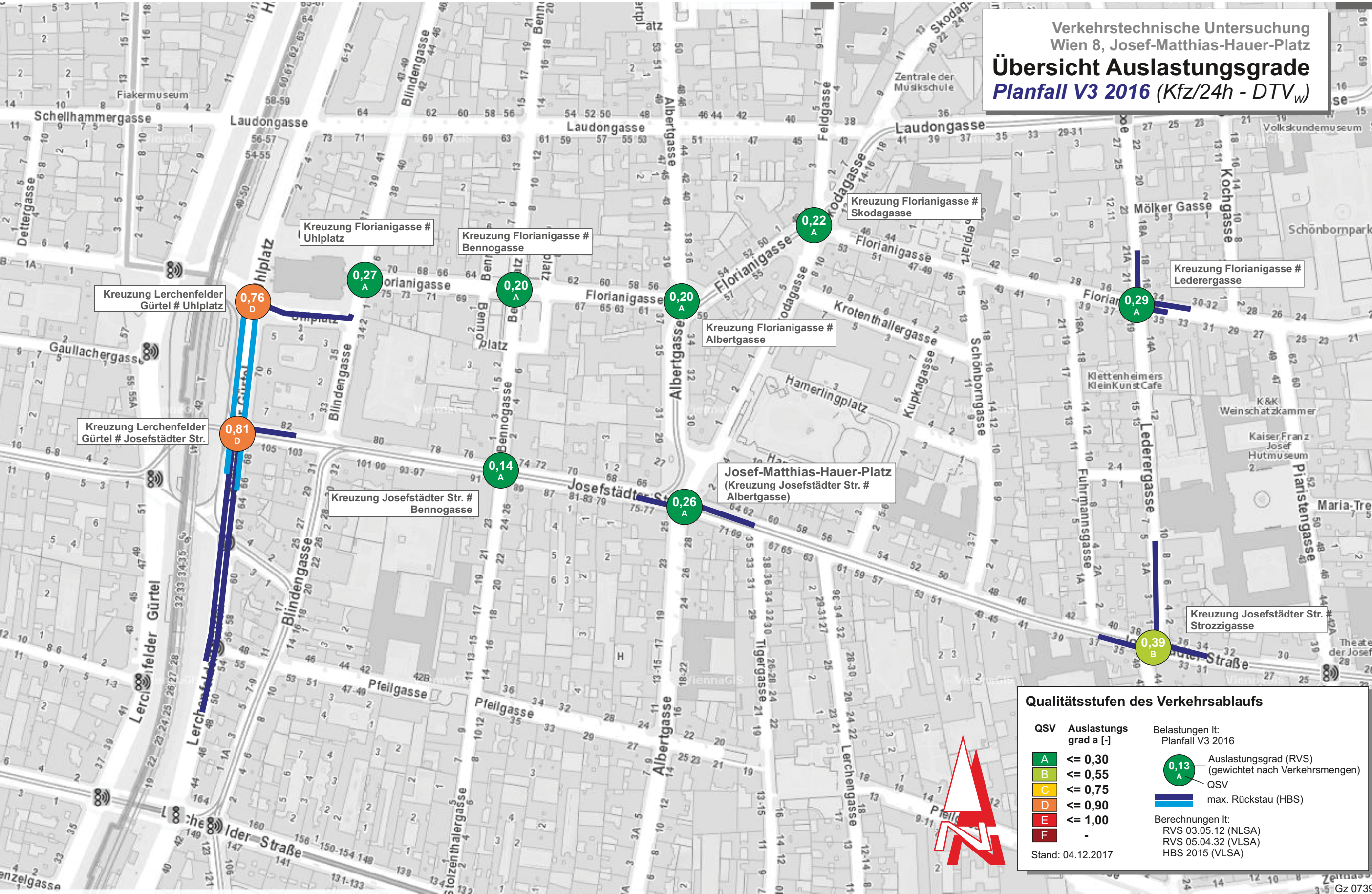
Abbildung 3-7: Übersicht Auslastungsgrade - Planfall V3 2016
