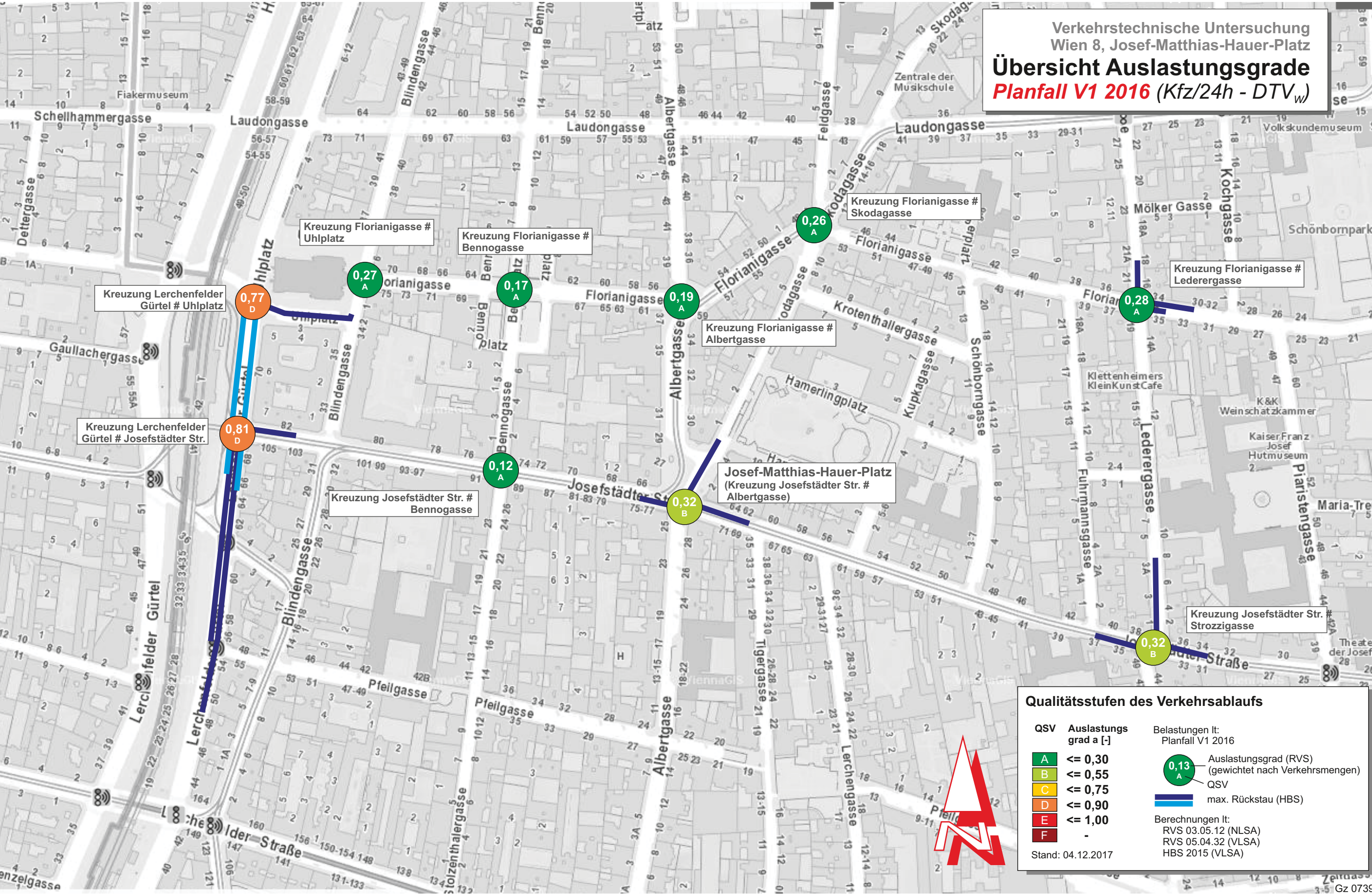
Abbildung 3-3: Übersicht Auslastungsgrade - Planfall V1 2016
