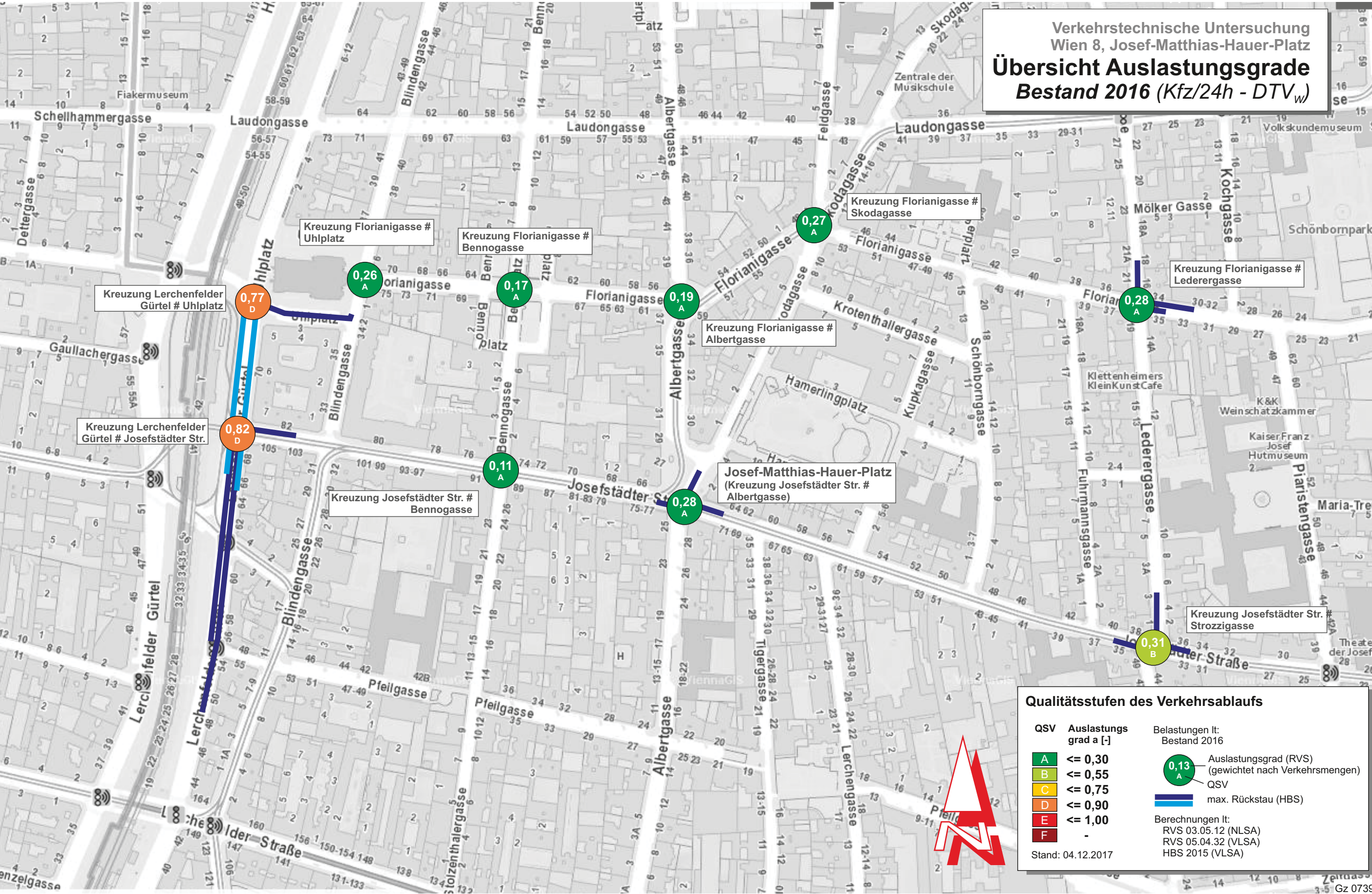
Abbildung 3-1: Übersicht Auslastungsgrade - Bestand 2016
