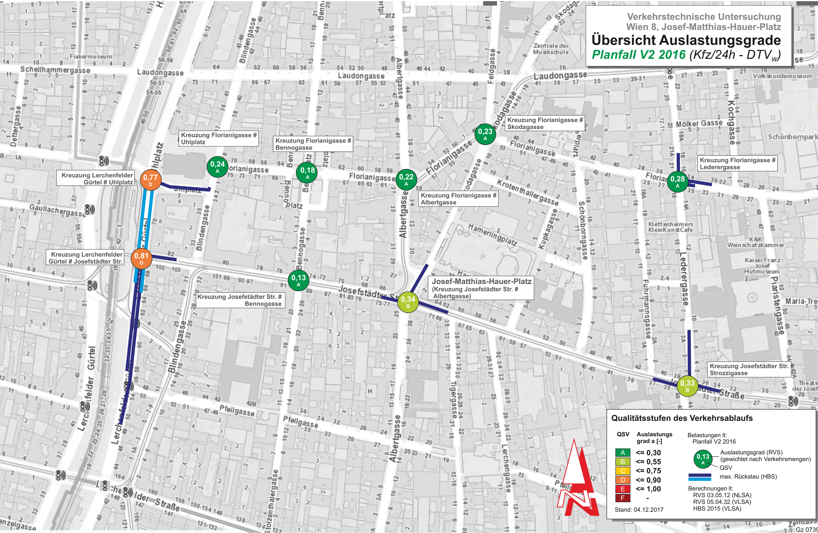
Abbildung 3-5: Übersicht Auslastungsgrade - Planfall V2 2016
