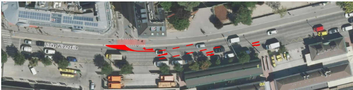
Abbildung 5: Schaffung einer Einbiegespur in die Laimgrubengasse durch Reduktion der Anzahl geradeaus führender Fahrspuren von zwei auf eine.
