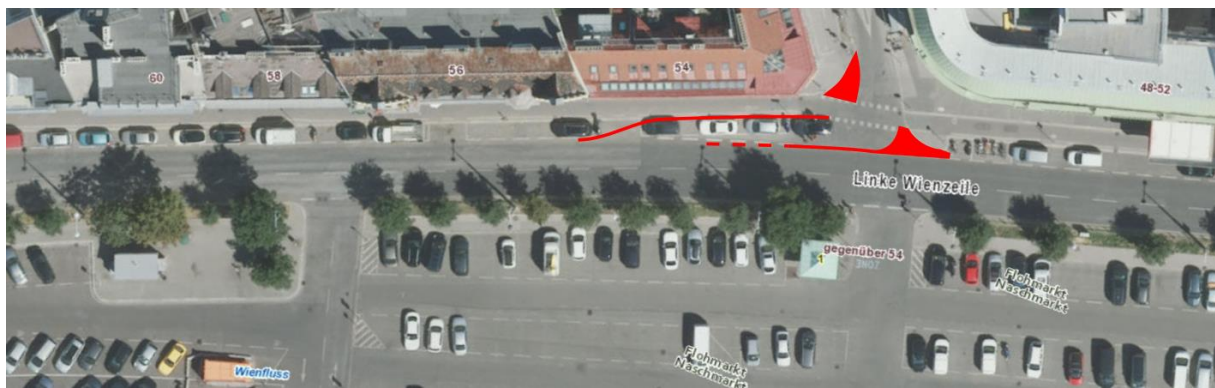
Abbildung 9: Schaffung einer Einbiegespur von der Joanelligasse.
