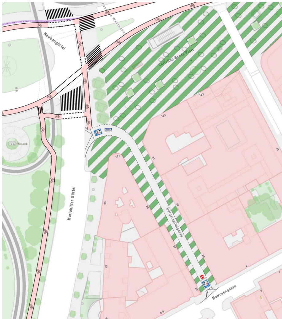
Abbildung 1: Prinzipskizze einer möglichen Umgestaltung des Christian-Broda-Platzes unter Einbeziehung der Bürgerspitalgasse mit Schaffung neuer Radwegverbindungen. Grün schraffiert sind die Flächen, die für eine Neugestaltung mit maximaler Aufenthaltsqualität und Stadtklimawirkung zur Verfügung stehen.
