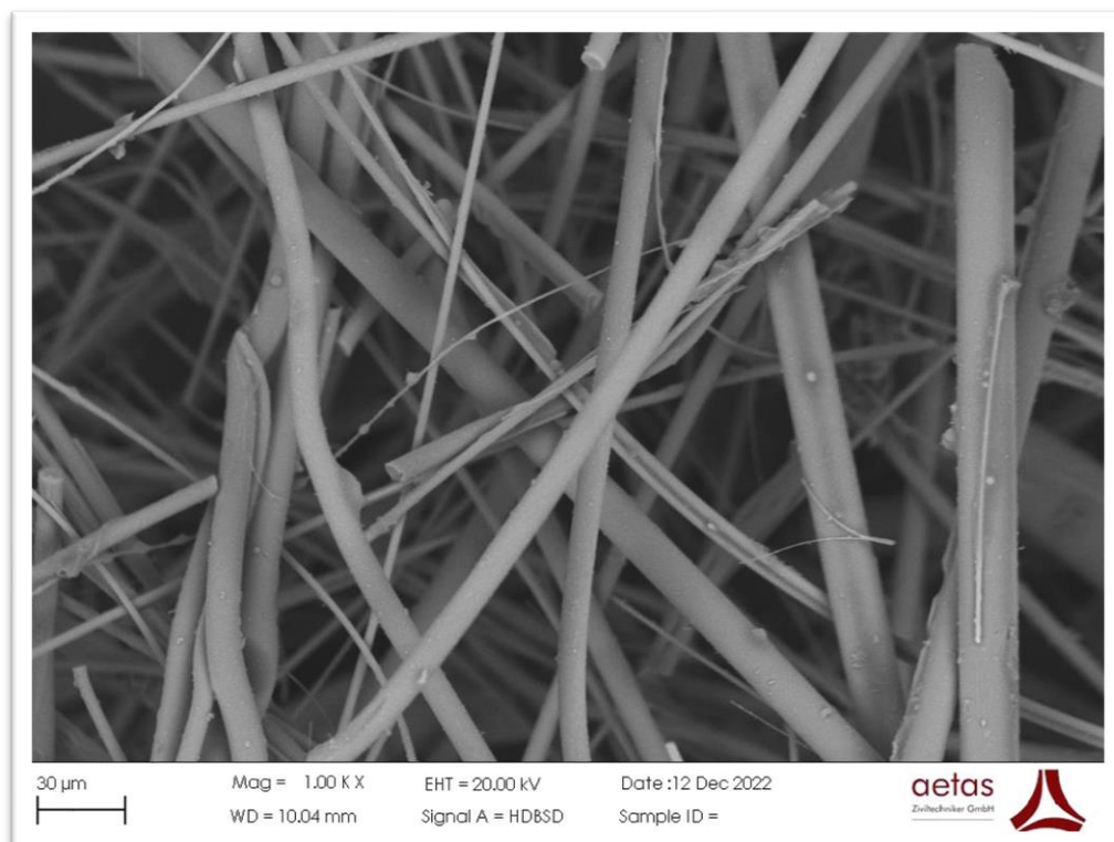
Bild 7: Künstliche Mineralfasern (KMF-Dämmung) bei 1.000-facher Vergrößerung, REM-Aufnahme (Quelle: aetas Ziviltechniker GmbH)
