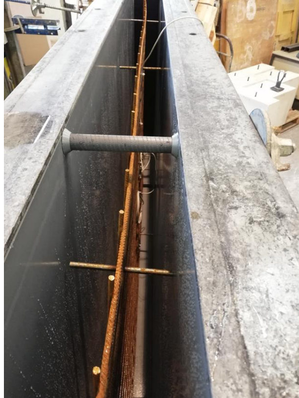
Abb. 4: Messstellen an der Bewehrungsmatte, Wand
