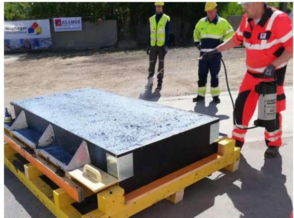
Abb. 15: Schritt 4 = Aufbringen des Verdunstungsschutzes an der Decke RCC2+
