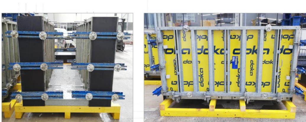
Abb. 3: Aufbau Wandschalung auf Trägerrost für Manövrieren und Umheben mit Gabelstapler; links Ansicht Stirnseite, rechts Ansicht Fläche
