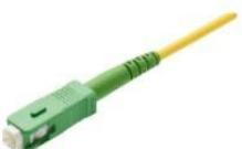
SC-Stecker nach IEC 61754-4, Zirkonia (Keramik) Ferrule mit Steckerstirnfläche mit PC oder APC 8° Schrägschliff, justierbar in 60 Grad Schritten, Material PBT / UL 94 V-0, Knickschutz
