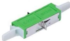
E2000™ Simplex Kupplung nach EN 186270 bzw. IEC 61754-15, Singlemode, für 8 Grad APC, Grade B, mit Flansch zur Montage mit Schrauben M2x8, Führungshülse Zirkoniakeramik, selbstschließende Laserschutzklappen aus Metall, halbtransparente Staubschutzkappe zur optischen Kontrolle ohne entfernen der Kappe, Kupplung qualifiziert nach IEC 61753-1-1 Kategorie U (uncontrolled environment), Logo seitlich eingeprägt, Material PBT/UL94 V-O
