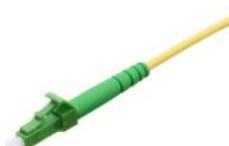
LC-Stecker nach IEC 61754-20, Zirkonia (Keramik) Ferrule, „push-pull“ Verriegelung, mit Steckerstirnfläche mit PC oder APC 8° Schrägschliff, justierbar in 60 Grad Schritten, Material PBT / UL
