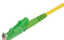
E-2000™ Stecker nach IEC 61754-15 bzw. EN 186270, „latched pull-push“ Verbindung, Zirkonia (Keramik) Ferrule mit Steckerstirnfläche mit PC oder APC 8° Schrägschliff, justierbar in 60 Grad Schritten, Material PBT / UL 94 V-0, Knickschutz grün, Material TPE / UL 94 V-0 und Metallstaubschutzklappe silbrig. Das Gehäuse/Hebel ist in nachstehenden Farbcodierungen verfügbar.
