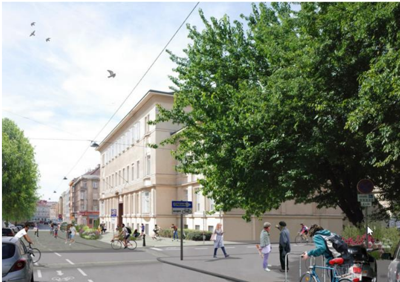
Bild 2: Kreuzungsbereich mit Gehsteigvorziehung, Fahrbahnaufdoppelung und Versetzung des Hinweisschildes.
