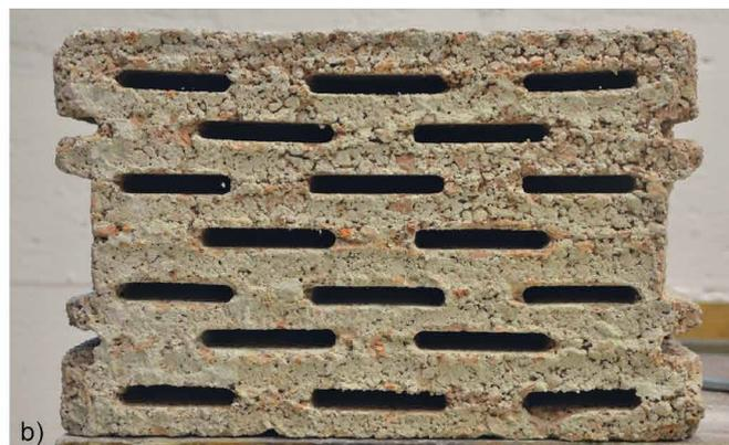
**Bild 1** Vibrostein: a) Längsseite, b) Unterseite: Lochbild
