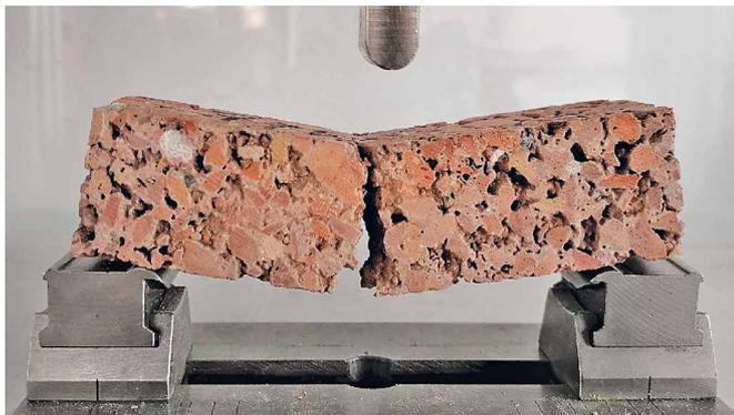
**Bild 6** Darstellung der 3-Punkt-Biegezugprüfung an Prismen mit den Maßen  $3 \times 3 \times 12 \text{ cm}^3$  (exemplarisch)
