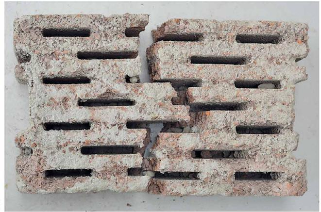
**Bild 5** a) Versuchsaufbau der 4-Punkt-Biegezugprüfung, b) Bruchschema (exemplarisch)
