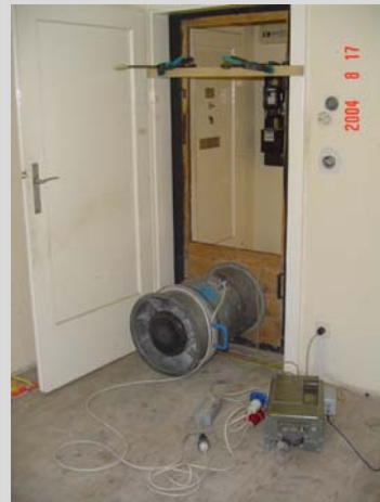
Bild 1: Prüfapparatur der Luftdurchlässigkeitmessung (Prüftüre, Ventilator, Steuergerät)
