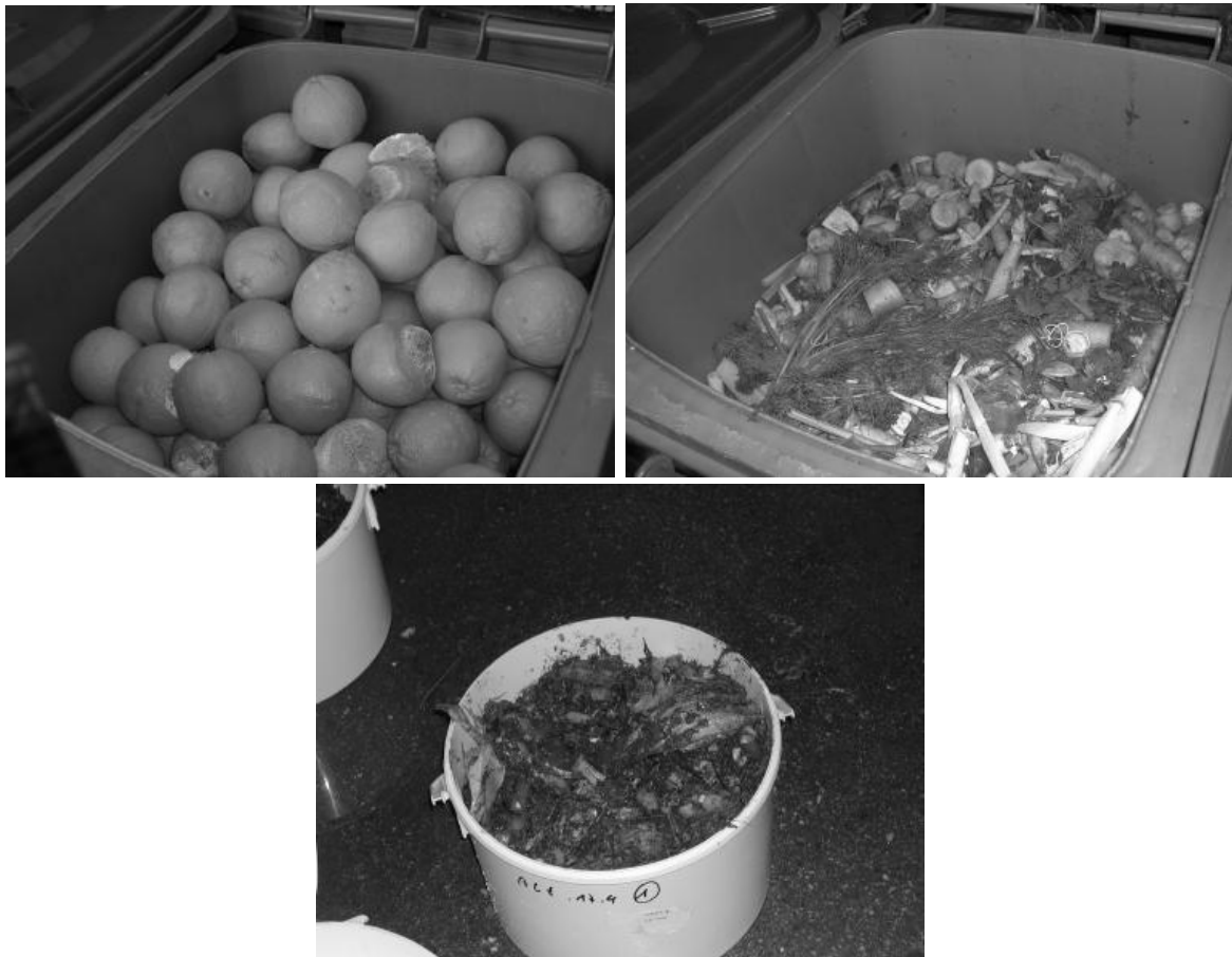
Abb. 6: Zur Biogasanlage BIOS 1 angelieferte Marktabfälle (das unterste Bild zeigt die Marktabfälle nach der Aufbereitung)
